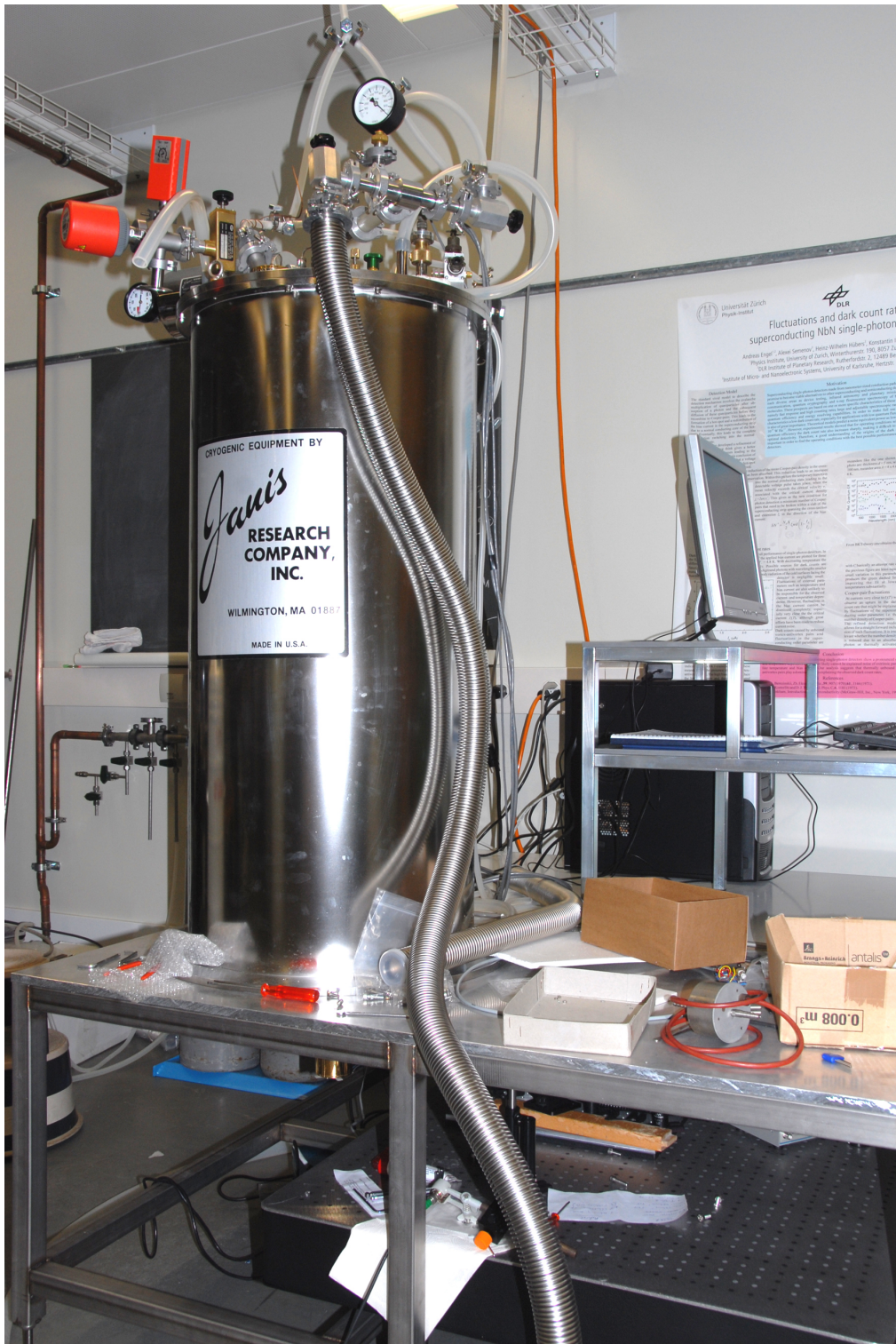
Abbildung 3.3: Der ^3\text{He} -Kryostat Janis HE-3-SOSV Adsorption Pumped Optical HE-3 Cryostat wie er im Tieftemperaturlabor des Instituts steht.
