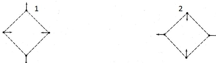
Abbildung 2.2.2: Auslenkungen aus der symmetrischen Konfiguration bei einer quadratischen Anordnung der Kerne. Diese Auslenkungen würden bei quantitativer Behandlung des Problems je einer Normalkoordinate entsprechen. (Abb. aus: [2], bearb.)
