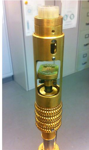
Abbildung 3.4: Probeneinsatz mit aufgebrachtem Probenhalter
