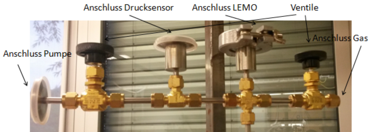
Abbildung 14: Anschlüsse für Drucksensor und LEMO inklusive Be- und Entlüftung
